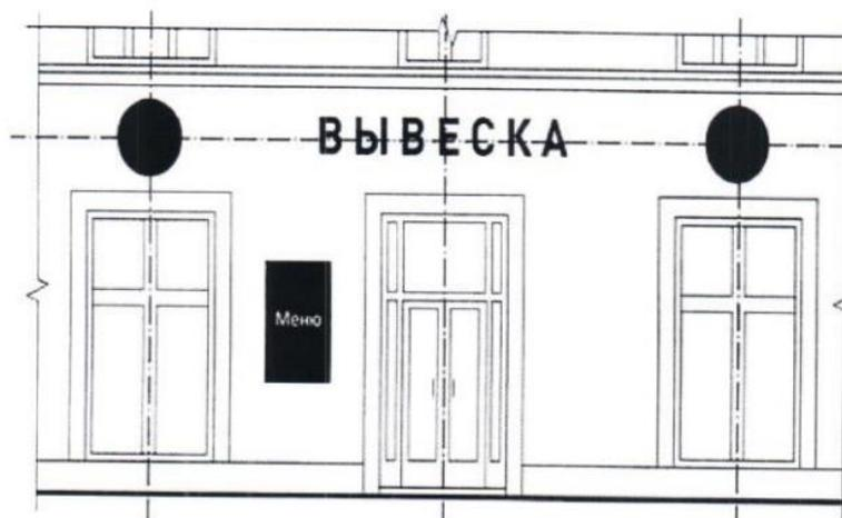
Подвесная конструкция (конструкция вывесок размещается в пешеходном галерейном пространстве зданий, строений, сооружений).
