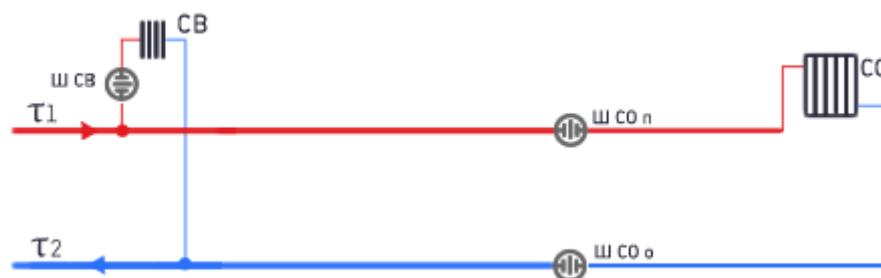
Рисунок 7 – Схема с непосредственным присоединением СО котельных с. Дутово, «Школа» и «Больница»
